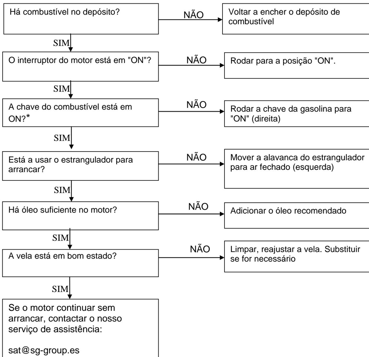
\*Lembrar que os modelos NERVION, TAJO e CANTABRICO têm duas válvulas de gasolina, ambas devem estar abertas para o funcionamento da motobomba.
