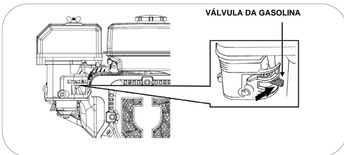
**IMPORTANTE:** Os modelos **TAJO**, **NERVION**, **CANTABRICO** dispõem de uma válvula de gasolina adicional na saída do depósito de combustível, abrir rodando para a posição vertical, os restantes modelos com depósito normalizado não têm esta válvula.
