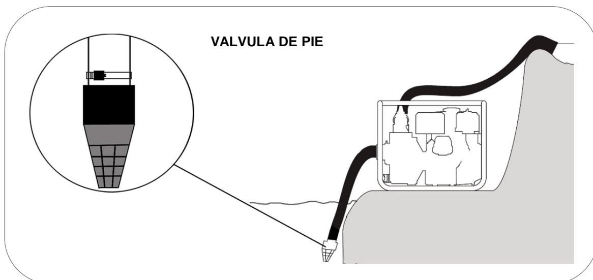
En el primer uso de la motobomba (**si se usa válvula de pie**) rellenar la manguera y cuerpo de bomba por completo de agua. En siguientes usos no será necesario al quedar siempre llena de agua.
