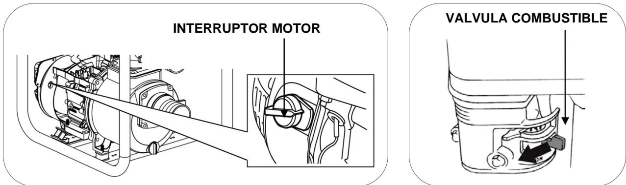
En modelos **NERVION, TAJO, CANTABRICO** cierre la válvula de gasolina secundaria situada en la salida del tanque de combustible, el resto de modelos no tienen esta válvula.
