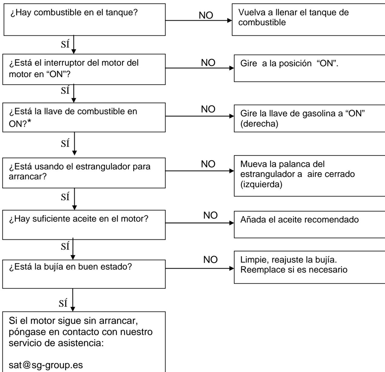
\*Recuerde que los modelos NERVION, TAJO y CANTABRICO tienen dos válvulas de gasolina ambas deben estar abiertas para el funcionamiento de la motobomba.
