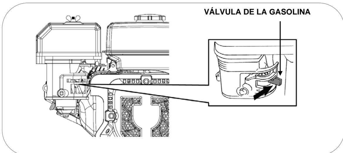
**IMPORTANTE:** Los modelos **TAJO**, **NERVION**, **CANTABRICO** disponen de una válvula de gasolina adicional en la salida del tanque de combustible, abra girando a posición vertical, el resto de modelos con depósito estándar no tienen esta válvula.
