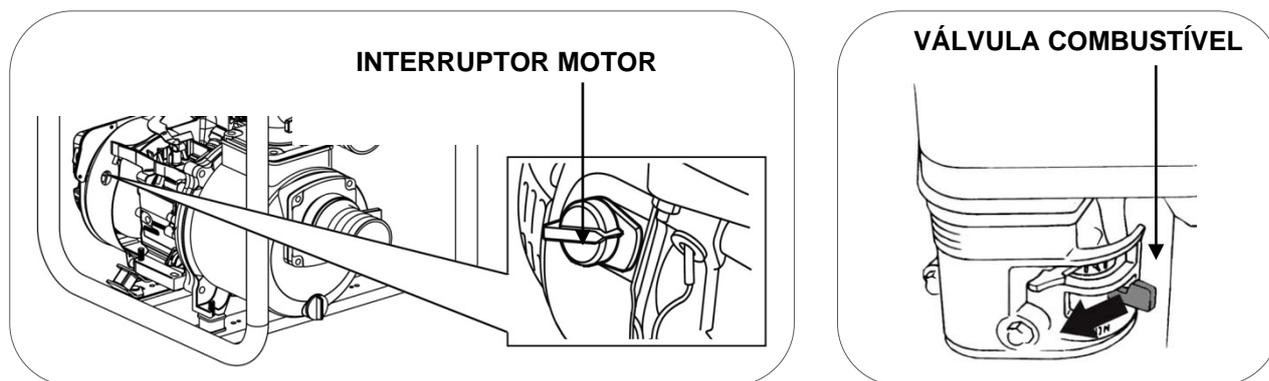
Nos modelos **NERVION, TAJO, CANTABRICO** fechar a válvula de gasolina secundária situada na saída do depósito combustível, os restantes modelos não têm esta válvula.
