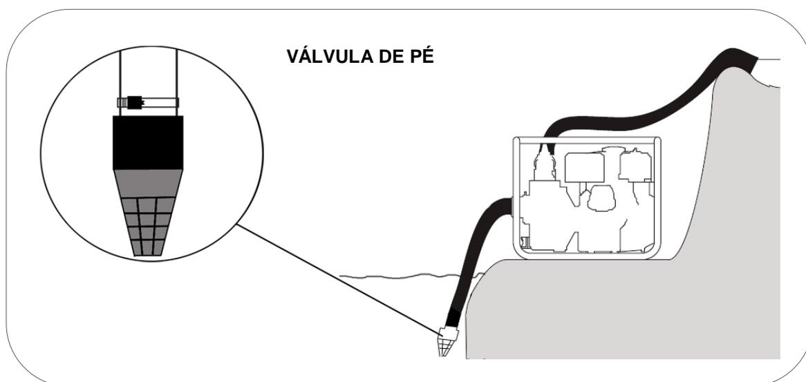
Na primeira utilização da motobomba (**se se usa válvula de pé**) encher completamente a mangueira e o corpo da bomba de água. Nas utilizações seguintes não será necessário por ficar cheia de água.
