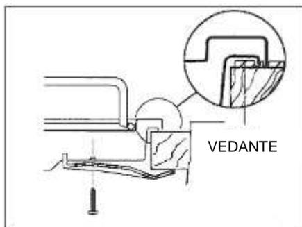
A extremidade da placa forma uma vedação dupla impedindo a infiltração de líquidos.
