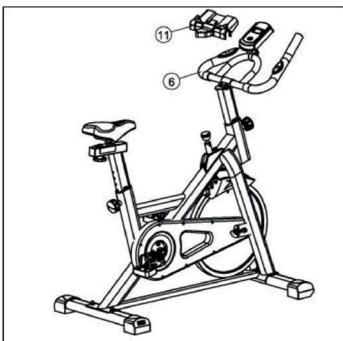
Monte el soporte del teléfono móvil (11) en el bastidor del manillar (6).
