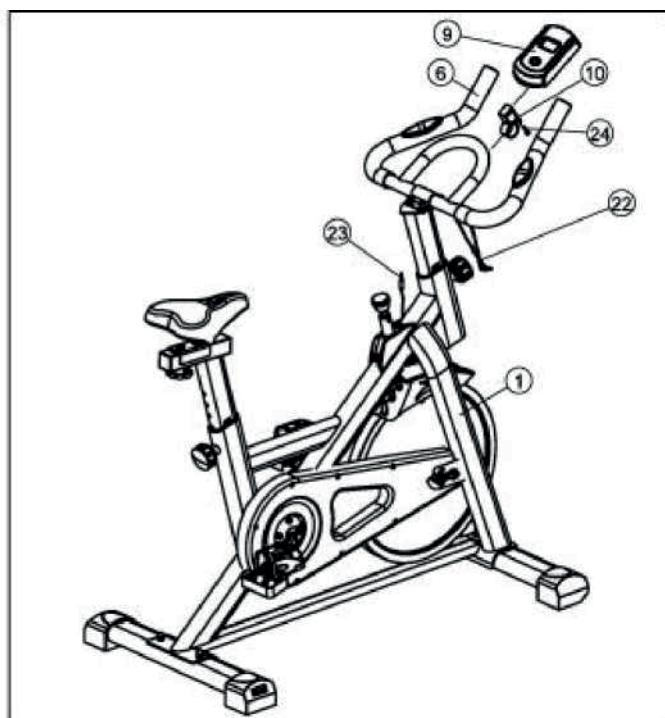
Tire del soporte del monitor (10), fíjelo en el bastidor del manillar (6) con el tornillo autorroscante (24) y apriételo con la llave hexagonal interior (27).
