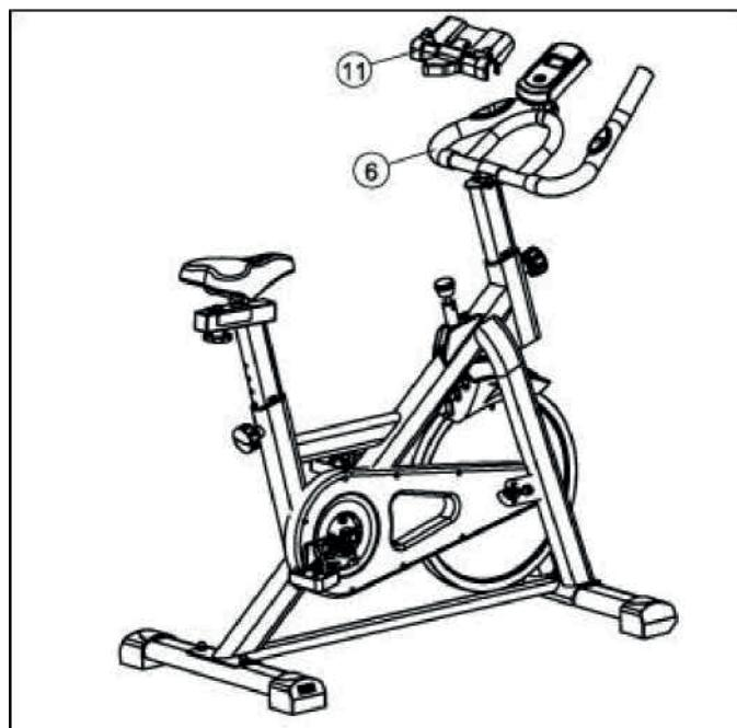
Montieren Sie den Mobiltelefonhalter (11) am Lenkerrahmen (6).
