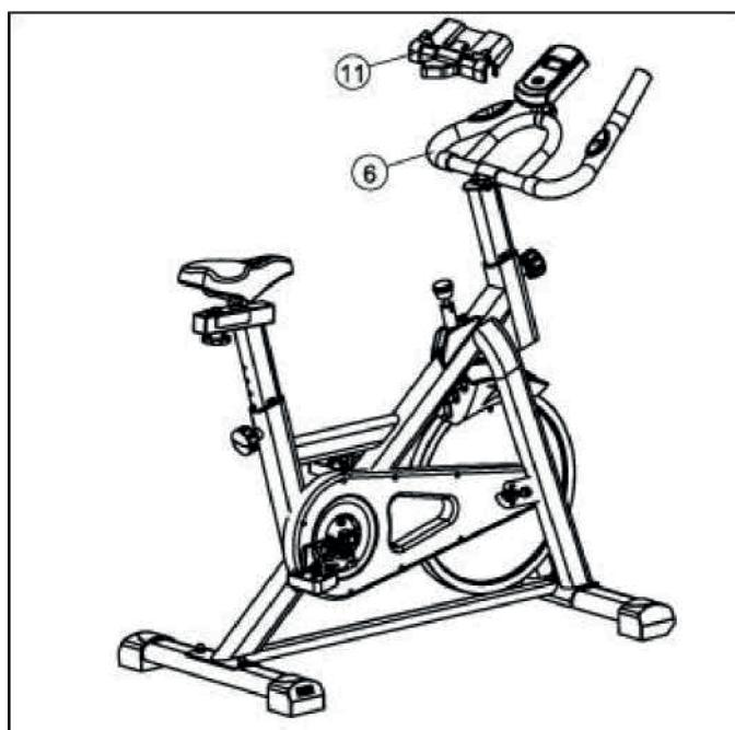
Montare il portacellulare (11) sul telaio del manubrio (6).
