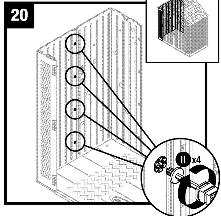
Ajuste la esquina trasera con cuatro pernos Easy Bolt (II). Avance desde el piso hacia el techo. **NO** use una llave de torsión. Use la herramienta Easy Driver (II) para pernos Easy Bolt y apriete manualmente. La cabeza del perno "Easy Bolt" estará al ras cuando esté completamente asentado. **NO** apriete demasiado los pernos "Easy Bolt".
