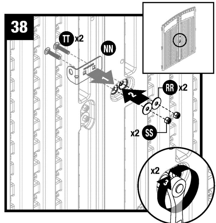
Inserte tornillos (TT) dentro de la placa del pestillo izquierdo (NN) y a través de la puerta **izquierdo**. Sujetando la placa en su lugar en el exterior de la puerta, asegure cada tornillo con dos arandelas (RR) y dos tuercas de cierre (SS).
