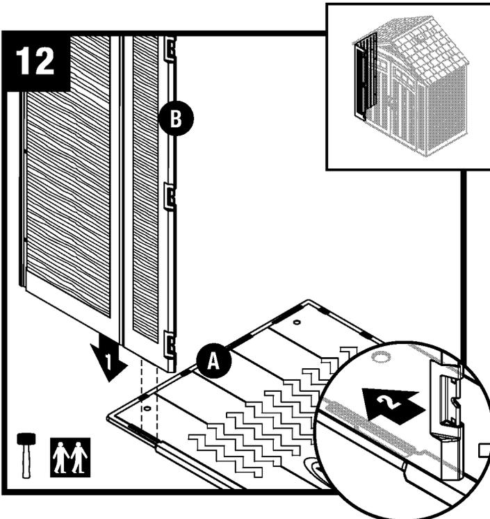
Alinee la lengüeta de la parte inferior de la esquina frontal izquierda (B) con la ranura del piso izquierdo (A). Descienda el panel dentro de la ranura del panel y asegúrelo en su lugar deslizándolo hacia fuera del piso.
