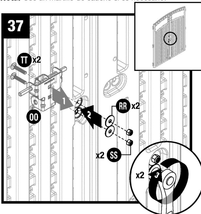
Inserte dos tornillos (TT) dentro de la placa del pestillo el derecho (OO) y a través de la puerta **derecho**. Sujetando la placa en su lugar en el exterior de la puerta, asegure cada tornillo con dos arandelas (RR) y dos tuercas de cierre (SS).
