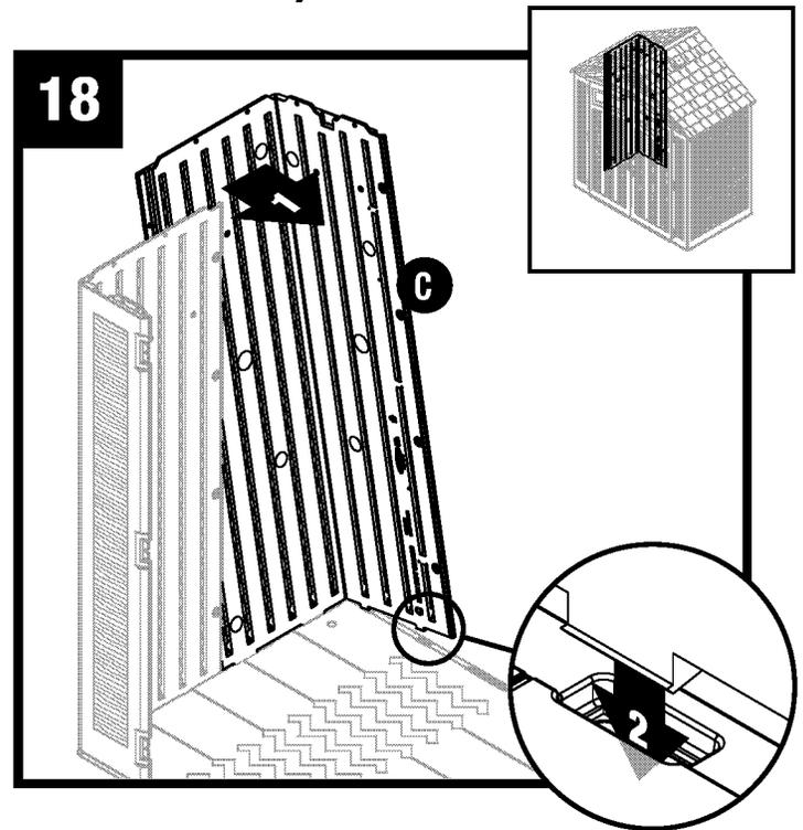
Regrese la esquina trasera izquierda (C) a su posición vertical y alinee las lengüetas inferiores del lado derecho con las ranuras en el piso. Nota: Escuchará un chasquido cuando la lengüeta esté completamente enganchada.
