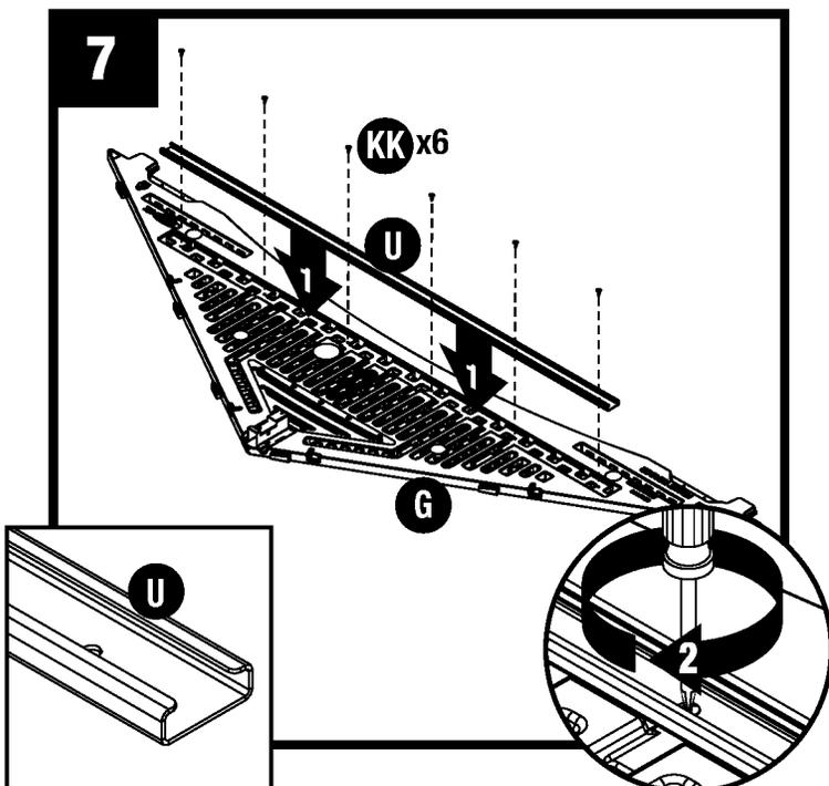
Coloque el aguilón frontal (G) sobre el piso con las letras hacia arriba. Coloque la viga del aguilón frontal (U, 57 pulg.) dentro del bolsillo en el interior del aguilón frontal (G). Instale con seis tornillos (KK)
