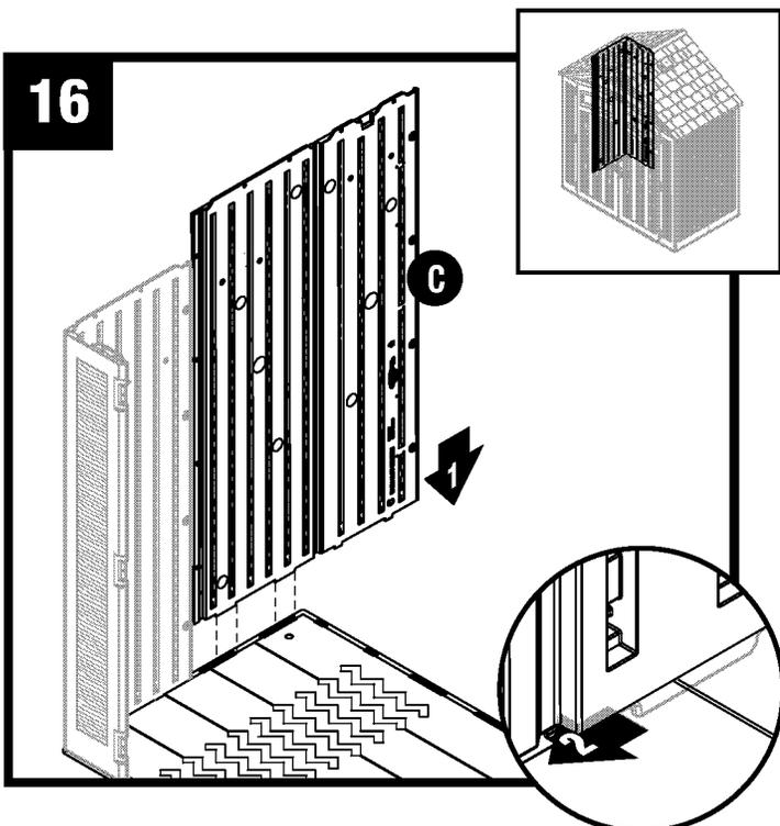
Alinee las lengüetas de la parte inferior del panel lateral (C) con las ranuras frontal y trasera. Descienda el panel dentro de las ranuras y asegúrelo en su lugar deslizándolo hacia la esquina frontal.
