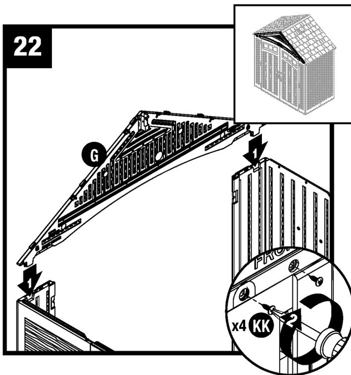
Coloque el aguilon frontal (G) sobre la abertura de la puerta y encaje los cuatro soportes protuberantes dentro de los bolsillos moldeados en las esquinas frontales. Asegure el aguilon frontal con dos tornillos (KK) en cada esquina frontal.
