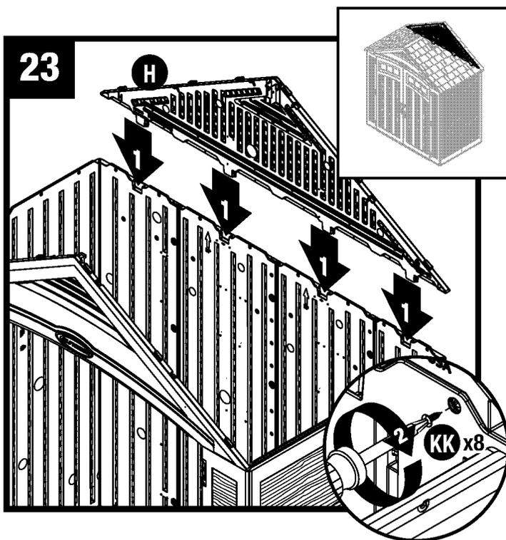
Coloque el aguilon trasero (H) sobre las paredes traseras y encaje los cuatro soportes protuberantes dentro de los bolsillos moldeados en las paredes traseras. Asegure el aguilon trasero con ocho tornillos (KK).
