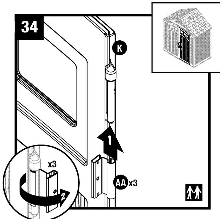
Coloque la puerta derecha (K) en posición vertical con las tres monturas de bisagra orientadas hacia la derecha. Deslice e instale una placa de bisagra metálica (AA) sobre cada soporte de bisagra. Rote las bisagras hacia fuera de la puerta.
