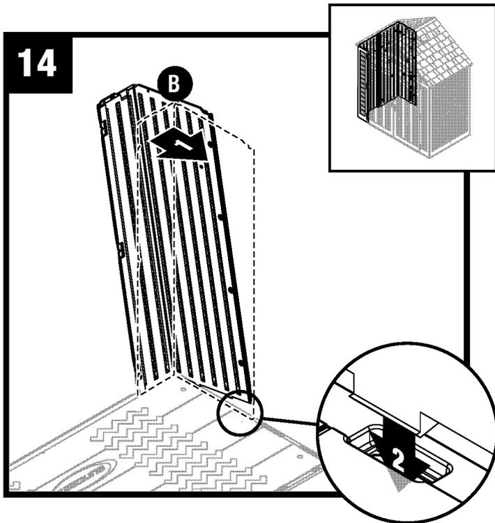
Regrese la esquina frontal izquierda (B) a su posición vertical y alinee las lengüetas inferiores del lado derecho con las ranuras en el piso.
