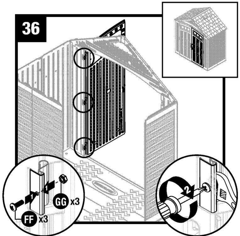
Asegure cada placa de bisagra metálica con un tornillo (FF) y una tuerca de cierre (GG).
