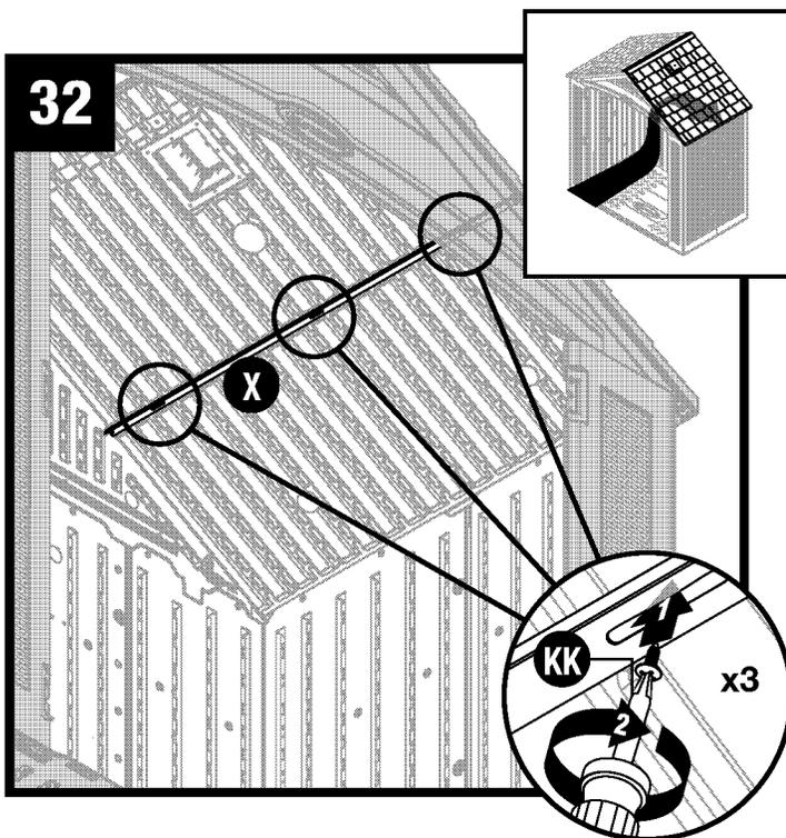
Asegure el soporte del techo (X) al techo con tres tornillos (KK). Eleve el segundo soporte del techo (X) a la parte de arriba del panel del techo.
