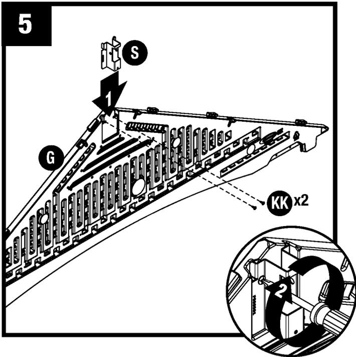
Deslice el soporte de la viga de caballete del techo (S) debajo de las lengüetas en el interior de la cima del aguilón frontal (G) y asegure con dos tornillos (KK). NO apriete más de lo necesario los tornillos.
