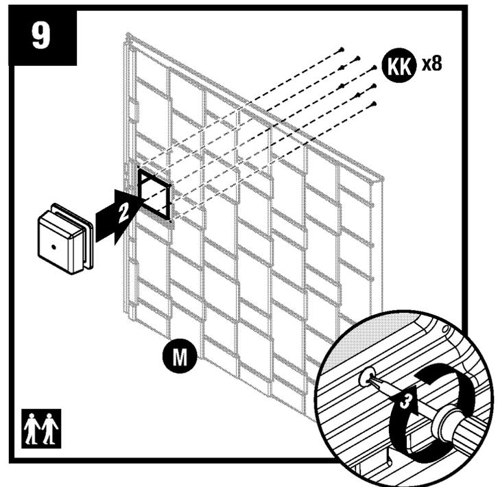
Coloque el ensamblaje Illumivent™ (Y,Z,W) sobre el panel del techo derecho (M). Asegure desde abajo con ocho tornillos (KK). Entornille las esquinas primero. Asegúrese de que el acanalado de las partes de plástico esté completamente asentado contra la empaquetadura en la cubierta Illumivent™. Repita el procedimiento con las partes restantes del panel de techo derecho.
