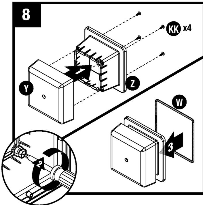
Coloque la cubierta Illumivent™ (Y) sobre la base (Z). Asegure desde abajo con cuatro tornillos (KK). Coloque la empaquetadura (W) dentro de la base de Illumivent™ (Z).
