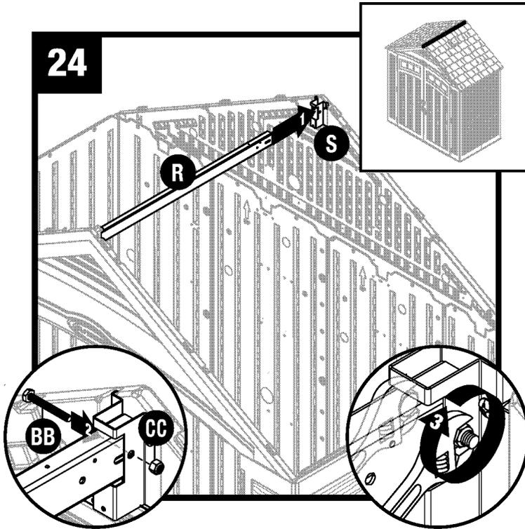
Eleve la viga del caballete (R) e introdúzcala dentro del soporte de la viga del caballete trasera del techo. Asegure con un perno hexagonal de 2 pulg. (BB) y una tuerca de cierre (CC). Repita el procedimiento con el soporte de la viga del caballete frontal.
