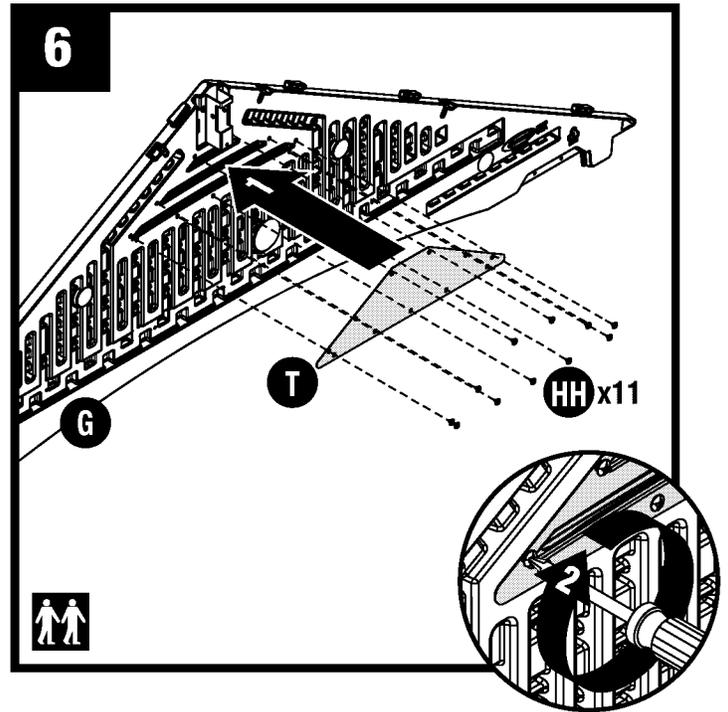
Coloque la malla de ventilación (T) en el aguilón frontal (G). Asegure a través de la parte trasera del aguilón con 11 tornillos (HH). NO apriete más de lo necesario los tornillos.
