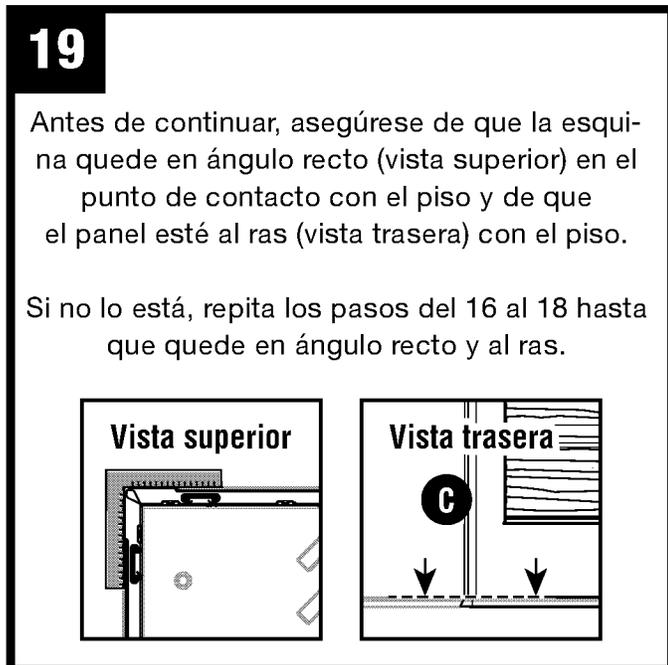
Antes de continuar, asegúrese de que la esquina quede en ángulo recto (vista superior) en el punto de contacto con el piso y de que el panel esté al ras (vista trasera) con el piso.
