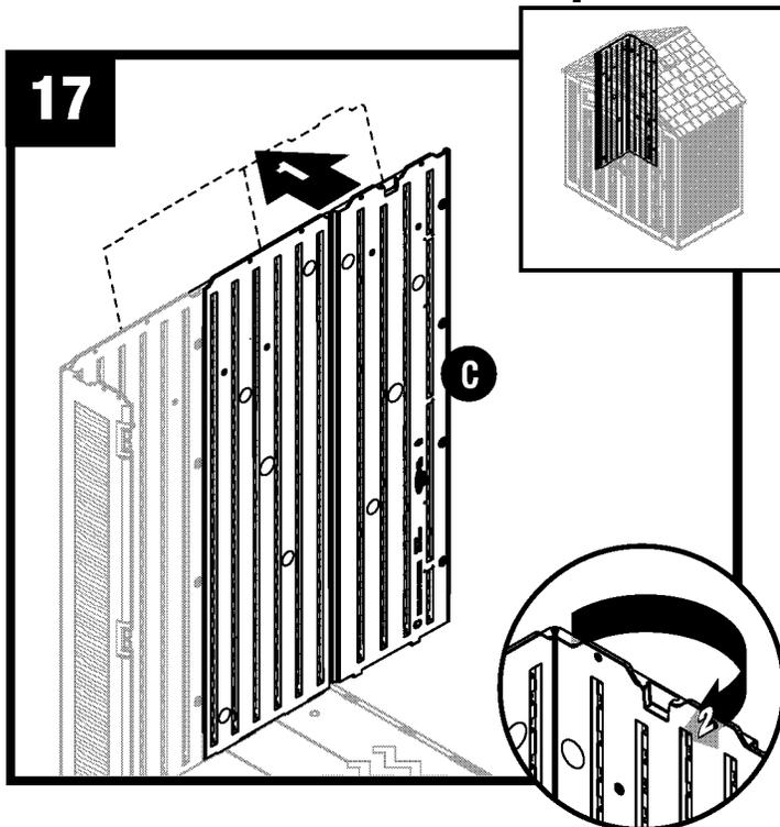
Incline un poco la esquina trasera izquierda (C) hacia afuera y doble la bisagra de la esquina.
