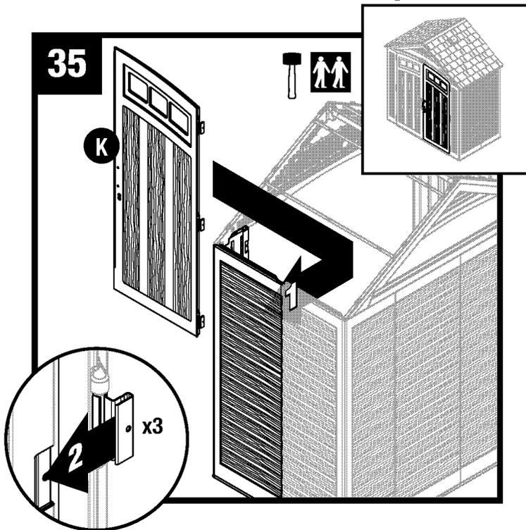
Con la placa de la bisagra abierta, deslice una bisagra sobre cada receptáculo en el interior del panel frontal derecho.
