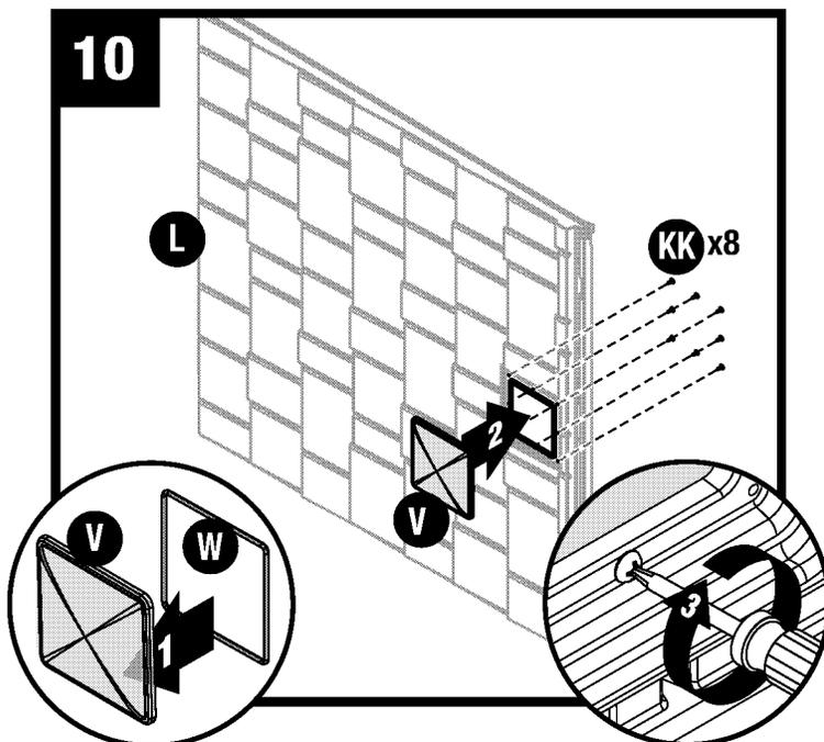
Coloque la empaquetadura del tragaluz (W) dentro del tragaluz (V). Coloque el tragaluz (V) sobre el panel de techo izquierdo (L). Asegure desde abajo con ocho tornillos (KK). Entornille las esquinas primero. Asegúrese de que el acanalado de las partes de plástico esté completamente asentado contra la empaquetadura del tragaluz. Repita el procedimiento el panel de techo izquierdo.
