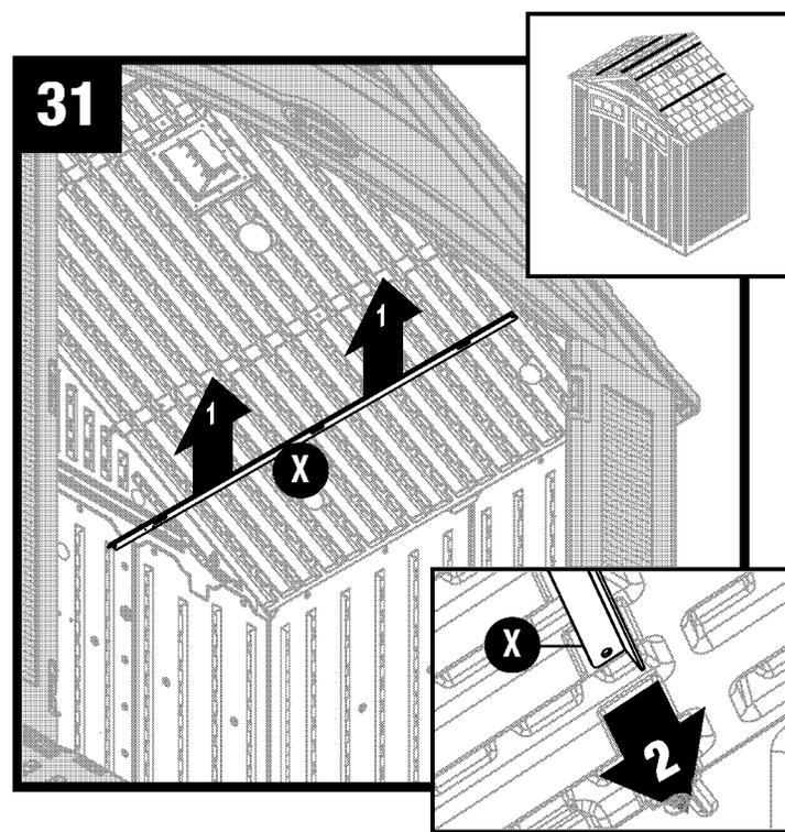
Eleve el soporte del techo (X) en su posición contra el techo. Deslice el soporte del techo (X) dentro del aguilón frontal. Asegure el soporte del techo a la parte inferior del soporte de la armadura con un tornillo (NN).
