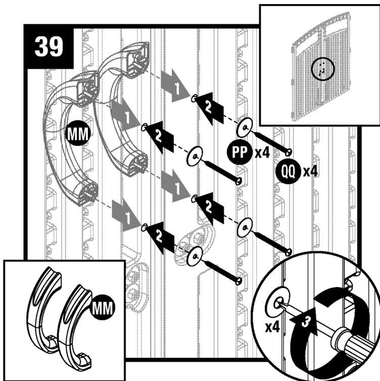
Desde la parte exterior de las puertas, inserte los vástagos de la manija de la puerta (MM) dentro de los agujeros de las puertas izquierda y derecha. En el interior de las puertas, coloque arandelas (PP) en cada vástago de la manija de la puerta, y asegure cada uno con un tornillo (QQ).
