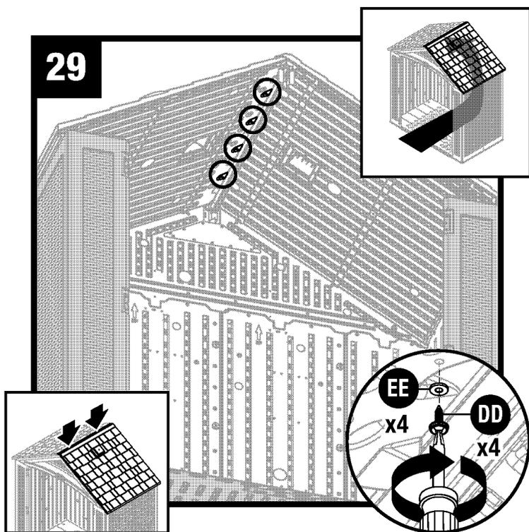
Desde afuera, presione hacia abajo los paneles del techo derecho con cimas. Desde adentro de la caseta, asegure las cimas del techo a los paneles del techo izquierdo con 4 arandelas selladoras de caucho (EE) y 4 tornillos selladores (DD).
